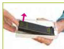
Espulsione manuale della batteria
